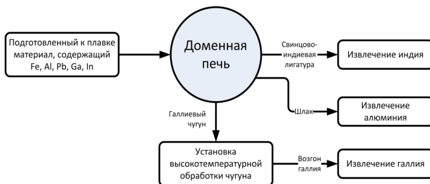
Рисунок 21 – Принципиальная схема переработки комплексной руды или техногенного материала, содержащего Fe, Al, Pb, Ga, In.
