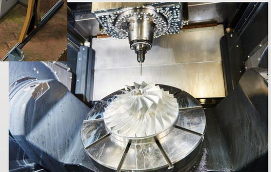
При этом финишная высокопроизводительная механическая обработка позволяет получить окончательную форму детали
